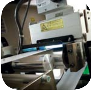
Mini coater allows coating tests on smaller scales
